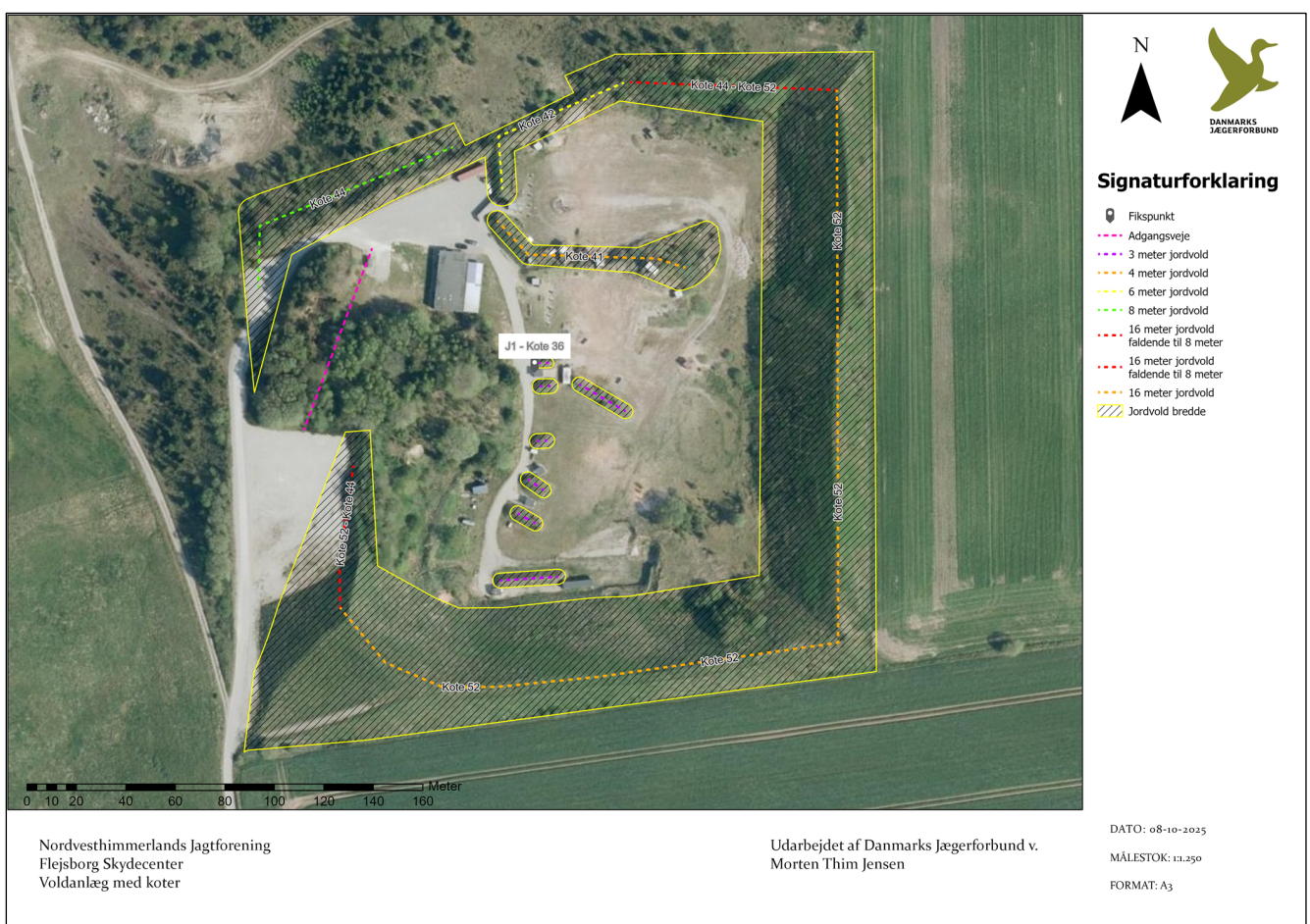
Figur 1. Koter, som anlægget må opbygges til.
